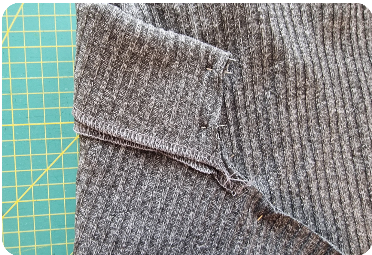
7. Detail obtočení přinechané podsádky předního dílu, pohled na zadní díl.
